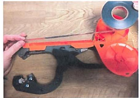
**Sollten Sie MAX Reflex Bindeband verwenden, dann achten Sie darauf, dass die glänzende Fläche nach der Bindung nach außen zeigt.**
