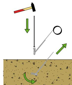
Mit Hilfe einer Einschlagstange den Erdanker, mit daran befestigtem Stahlseil, (mind. 40 cm) in den Boden einschlagen.
