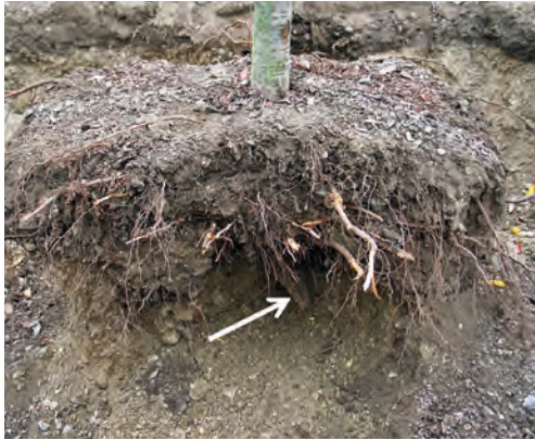
Abbildung 9: Seitlich unterhöhlte Pflanzsicherung arbofix af 40 mit abgewinkeltem Metallspieß
