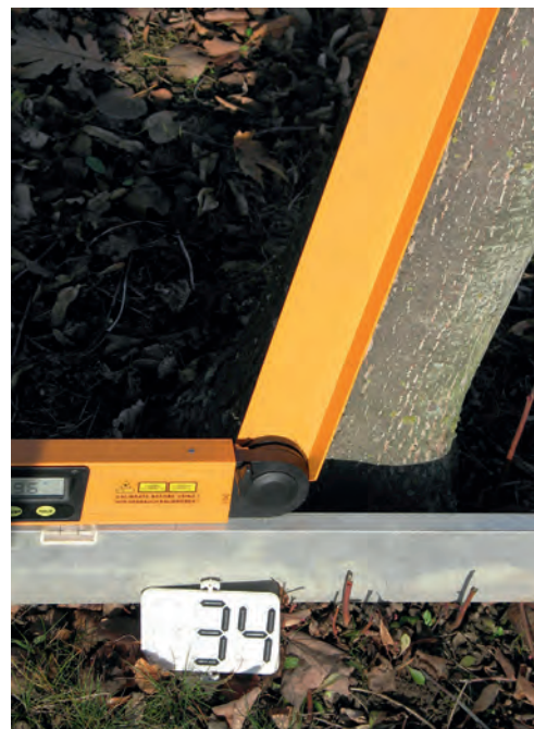
Abbildung 6: Messung der Stammneigungswinkel mit dem „Multi-Digit pro“
