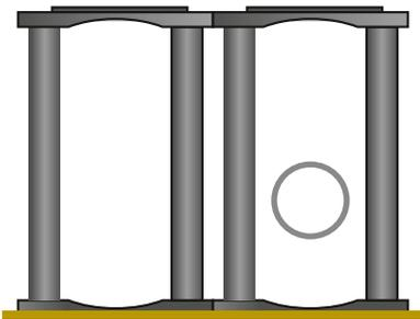
L'opzione più comunemente utilizzata è quella di far passare le utenze attraverso il sistema TreeParker. Grazie al design aperto delle unità, TreeParker può ospitare tubi, condotti e altre utenze sotterranee fino a 300 mm di diametro.
