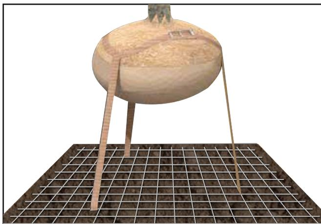
Assicurarsi che la rete in acciaio non influisca sulla planarità della sottobase per installare correttamente le unità TreeParker.
