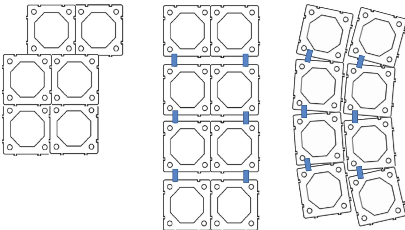
Per evitare lo spostamento delle unità durante il riempimento, collegare tutte le unità nel perimetro del sistema con distanziatori.
