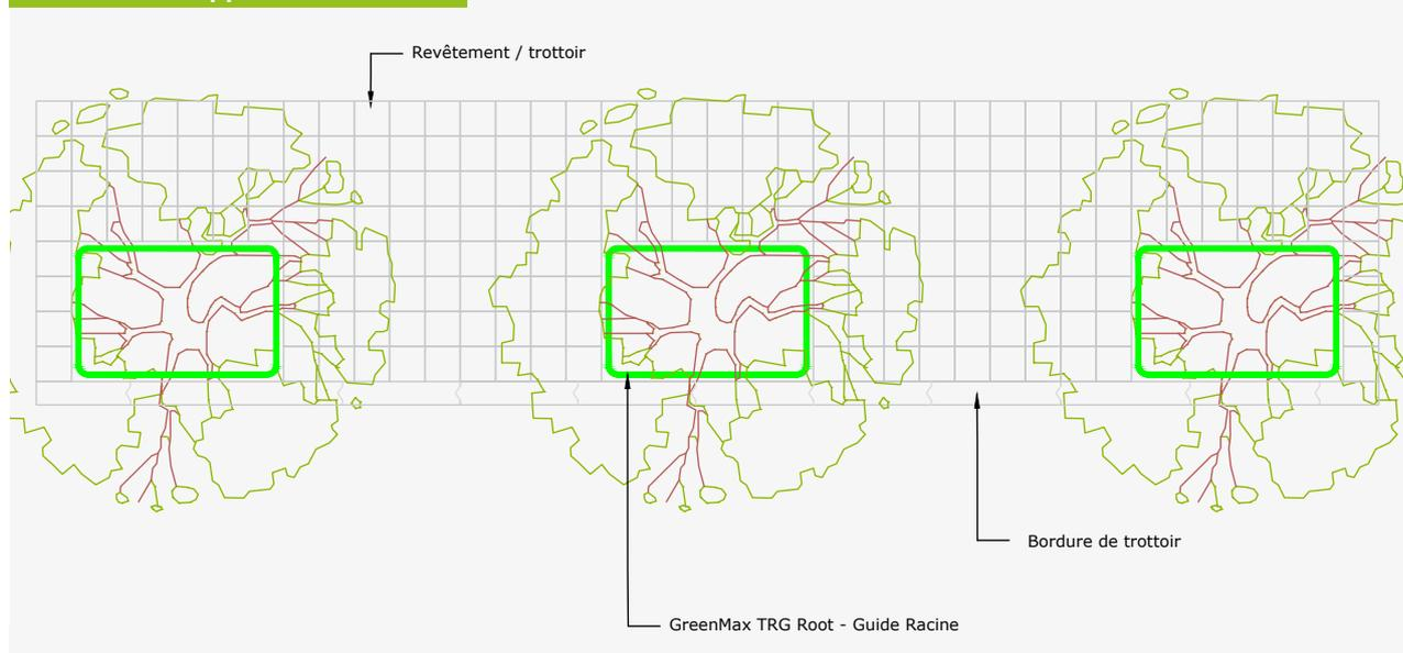
Le GreenMax Tree Root Guiding est une barrière permettant efficacement de maîtriser l'expansion des racines. Pour la protection de l'infrastructure autour ou à proximité de l'arbre sans devoir compromettre la santé ou la croissance de l'arbre. Peut être utilisée pour les plantations existantes et nouvelles.
